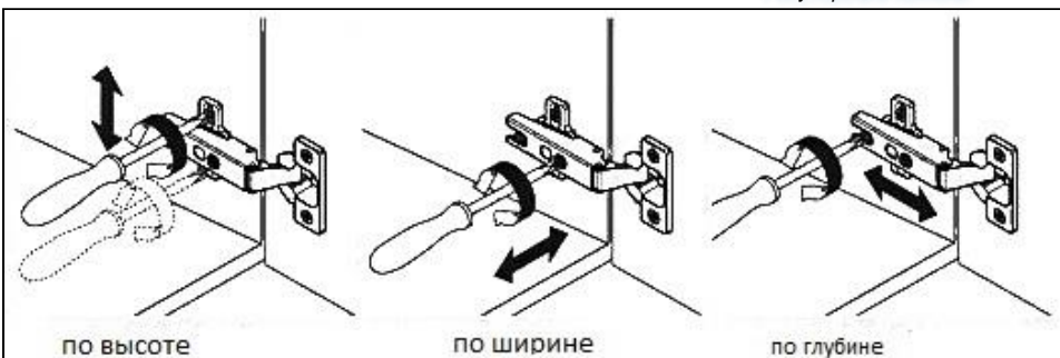
Регулировка петель:
