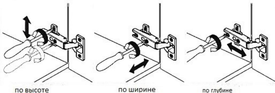
**Регулировка петель:****Сборка на конфирматы**
