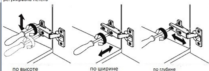
Регулировка петель:
